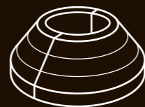
rosace 50 mm (diamètre) x 18 mm (hauteur), 16 mm diamètre du trou 55 mm (diamètre) x 20 mm (hauteur), 22 mm diamètre du trou
