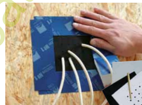
KAFLEX multi Manchette pour faisceau de câbles jusqu'à 16 câbles d'un diamètre de 6 à 12 mm
