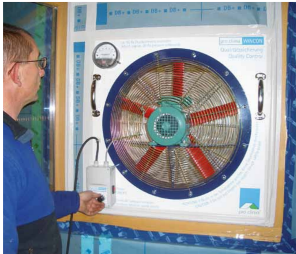
Le ventilateur de contrôle WINCON est monté dans une fenêtre ou une porte. La dépression créée dans le bâtiment aide à détecter les défauts d'étanchéité éventuels.
